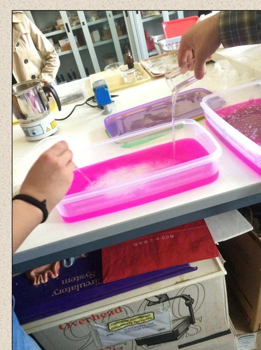
A szennyvízbe ecetet (savas kémhatású) csepegtettünk, így semlegesítettük a lúgos kémhatású oldatunkat, ezzel a baktériumok tevékenységét modelleztük a biológiai fázis során.
