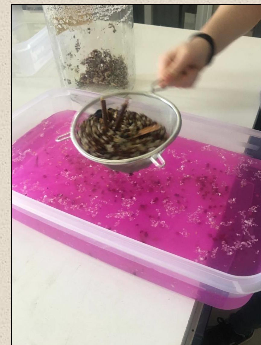
Nagylyukú rácsszűrő segítségével a befőttesüvegből egy csappal felszerelt dobozba szűrtük a szennyvizet, ezzel eltávolítva a nagyobb darabokat belőle.
