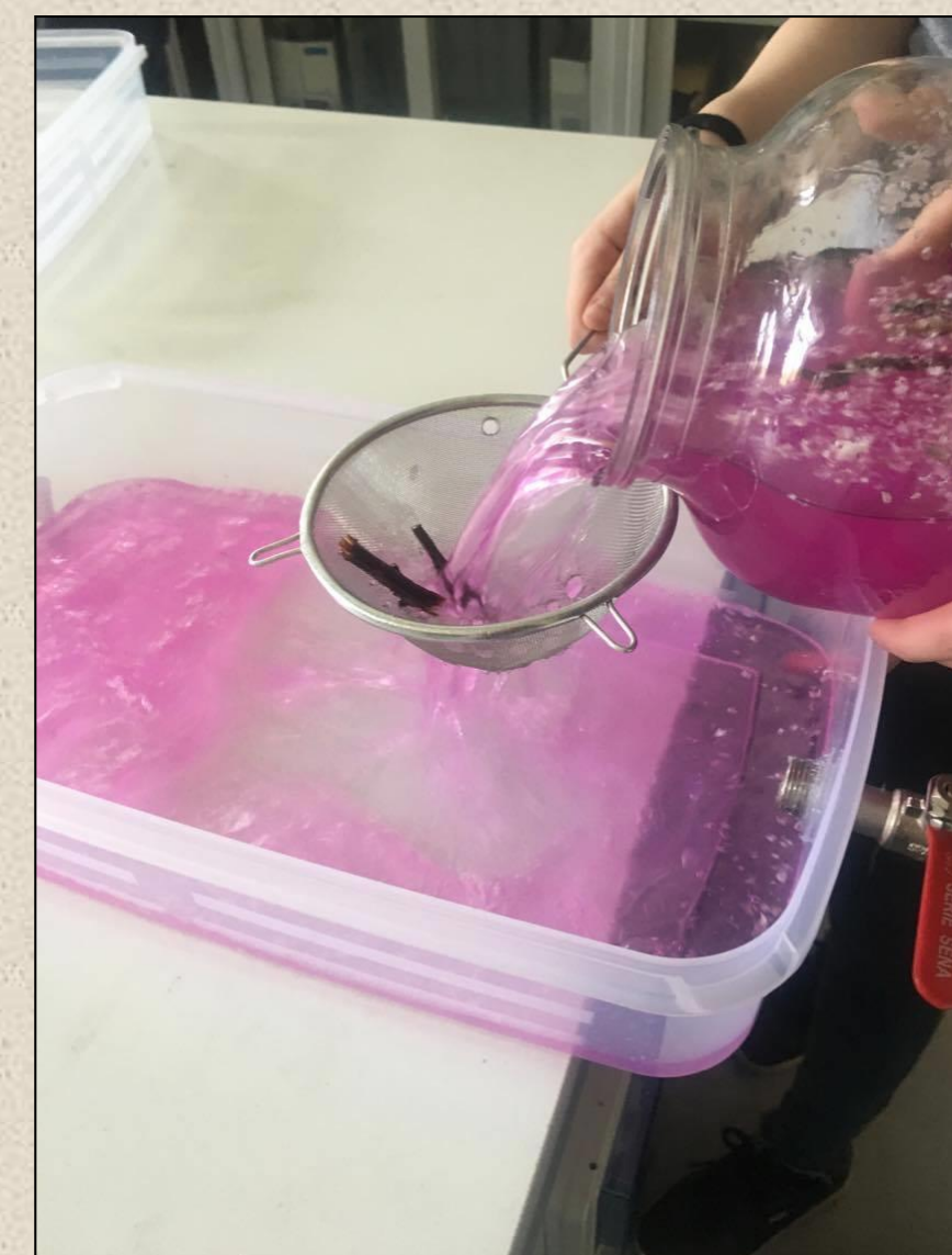
Nagylyukú rácsszűrő segítségével a befőttesüvegből egy csappal felszerelt dobozba szűrtük a szennyvizet, ezzel eltávolítva a nagyobb darabokat belőle.
