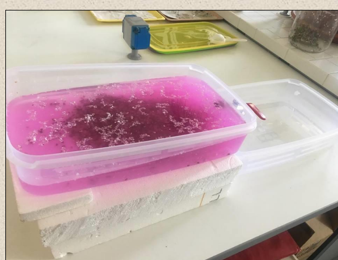
Kiülepítettük a homokot (lesüllyedt) és a gyertyaforgácsot (úszik a szennyvíz felszínén).
