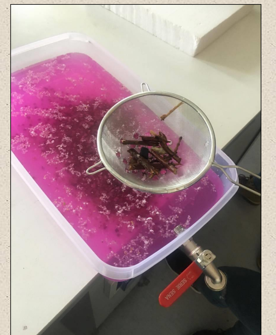
Nagylyukú rácsszűrő segítségével a befőttesüvegből egy csappal felszerelt dobozba szűrtük a szennyvizet, ezzel eltávolítva a nagyobb darabokat belőle.
